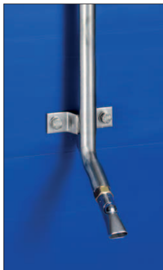
Нипел с топче за угоявани свине – високо налягане – ниски загуби на вода, тъй като животните трябва да захватят целия нипел
