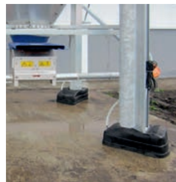
Кожух за краката на силоза с цел гарантирано точно претегляне при екстремни външни условия
